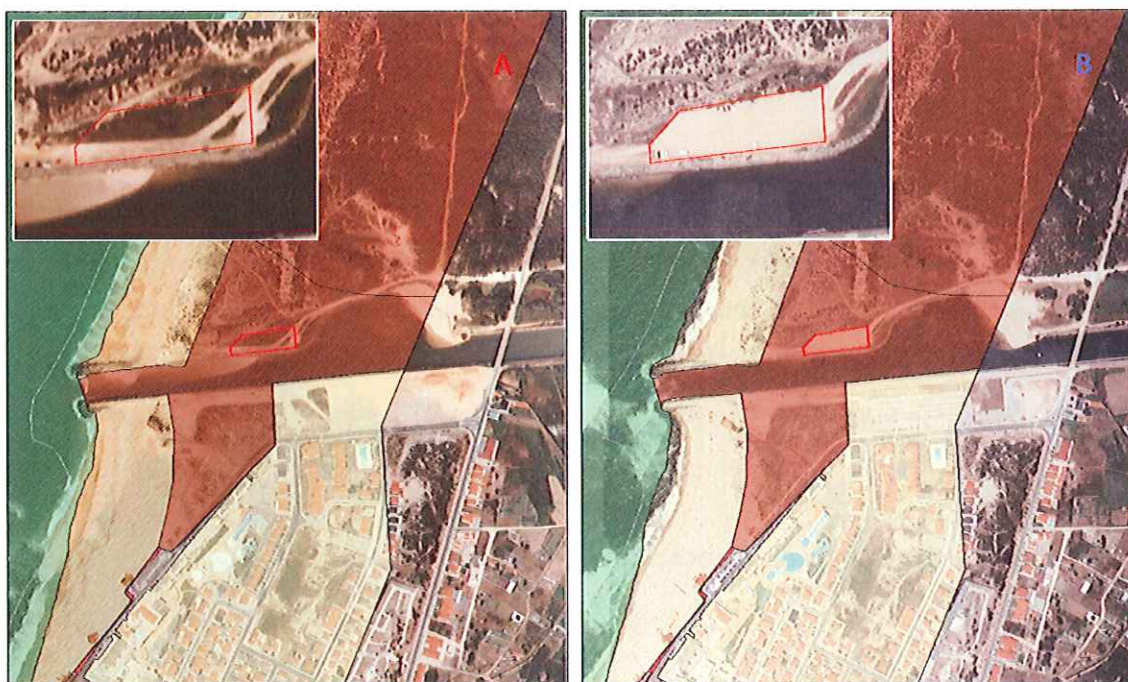
Figura 3 – Exemplo de identificação por fotointerpretação comparativa dos ortofotomapas (orto de 2004 [A] e orto de 2010 [B]), de ação potencialmente em conflito com o POOC em Vieira Norte Fonte: DGT (CAOP, ortofotomapas) / APA (planta de síntese do POOC vetorial)
