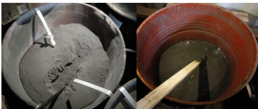
Figura n.º 31 – Resíduos de escórias do forno identificados que originou infração ao Reg. 1013/2006
