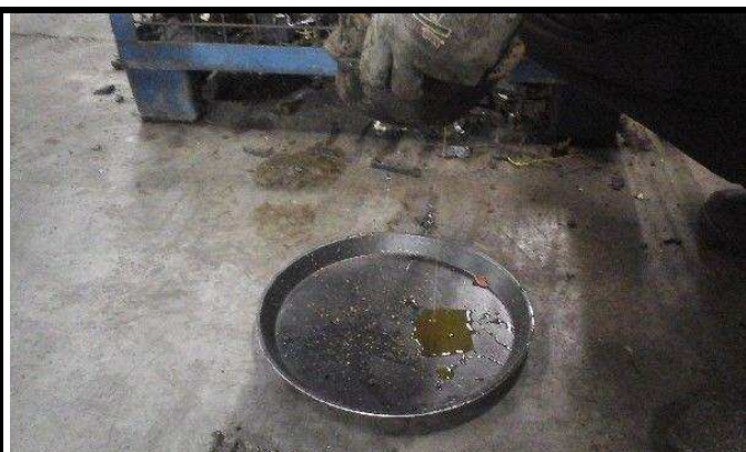
Fotografia 2 - Óleo vertido do interior do motocompressor
