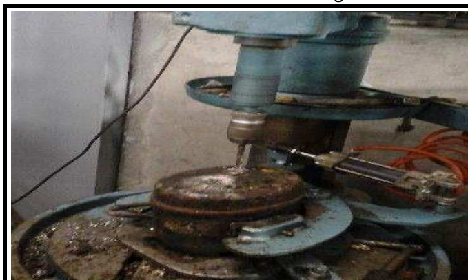
Fotografia 1 - Perfuração de motocompressor (por solicitação dos inspetores) provenientes de outros operadores, com vista a avaliar o nível de descontaminação
